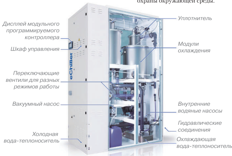
Рисунок 1. eChiller — «чистое» охлаждение водой из-под крана (фото: Efficient Energy)
