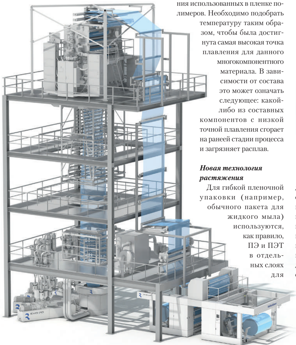
Reifenhäuser EVO Ultra Stretch: положение устройства растяжения непосредственно на выходе линии запатентовано и является уникальным решением для рынка
