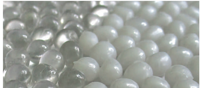
Типы гранул ПЭТ: аморфные (вверху) и полукристаллические (внизу)
